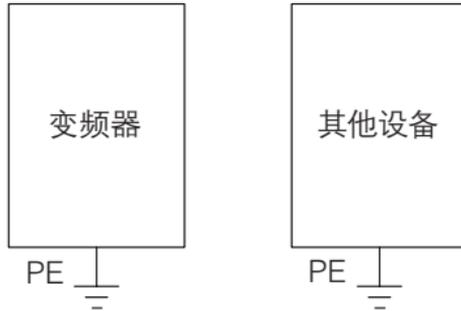
1. 应尽可能采用最大的接地电缆标准尺寸来降低的接地系统阻抗；
