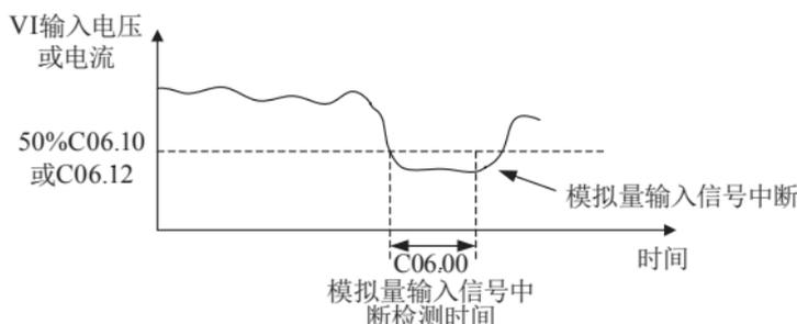
模拟量输入信号中断检测功能对模拟量输入端子AI也同样有效，只是对应参数为AI相关参数（C06.20和C06.22）。
