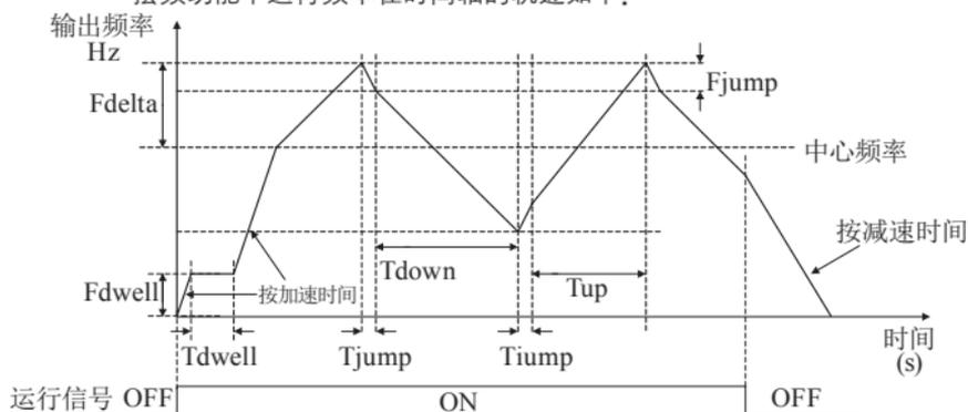
$F_{delta}$ : 摆幅、 $F_{dwell}$ : C30.01摆频预置频率、 $F_{jump}$ : 突跳频率
