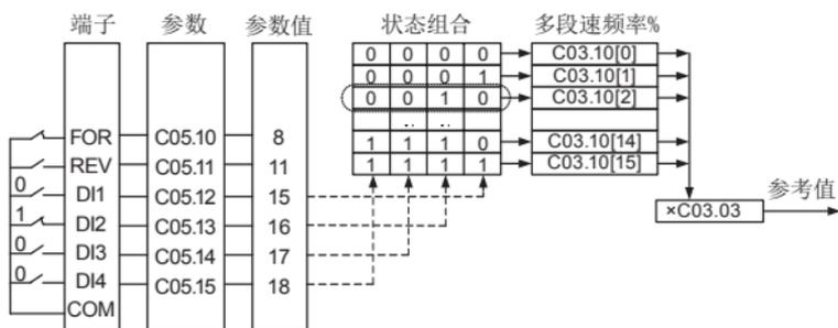
上图中，端子FOR、REV按两线模式1设置，DI1~DI4作为多段速频率的信号输入端，并由之依次组成4位二进制数，按状态组合值，挑选多段速频率。当(DI4、DI3、DI2、DI1) = (0、0、1、0)时，形成的状态组合数为2，此时挑选C03.10[2]设置的参考值百分比，由C03.10[2] × C03.03计算得到参考值（频率）。例如C03.10[2] = 20.00%，C03.03 = 50.000，则参考频率为10.0Hz。
