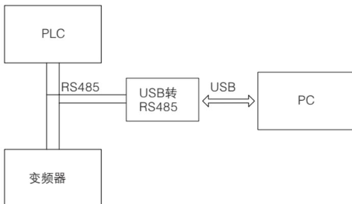
Modbus调试系统连线图
