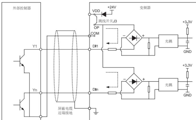
这种接线方式必须把跳线开关J3的OP连接到+24V上(变频器出厂跳线开关J3默认为NPN模式,即OP连接+24V)。基本型IO板无需跳线。
