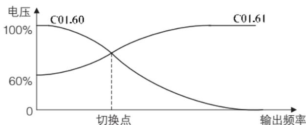
大部分应用场合只需设置低速负载补偿即可。调整此参数时，请在100%附近调整。对于启动力矩不足的情况，请逐步加大该值，直至满足启动要求即可。不可将低速负载补偿设置过大，否则容易导致变频器电流过大和电机发热严重。对于输出电流偏大的场合，可以适当减小该值。
