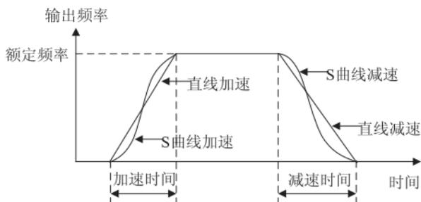
变频器一共定义了四种加减速时间，用户可以通过数字量输入端子切换选择，详见参数C05.1\*中的说明。
