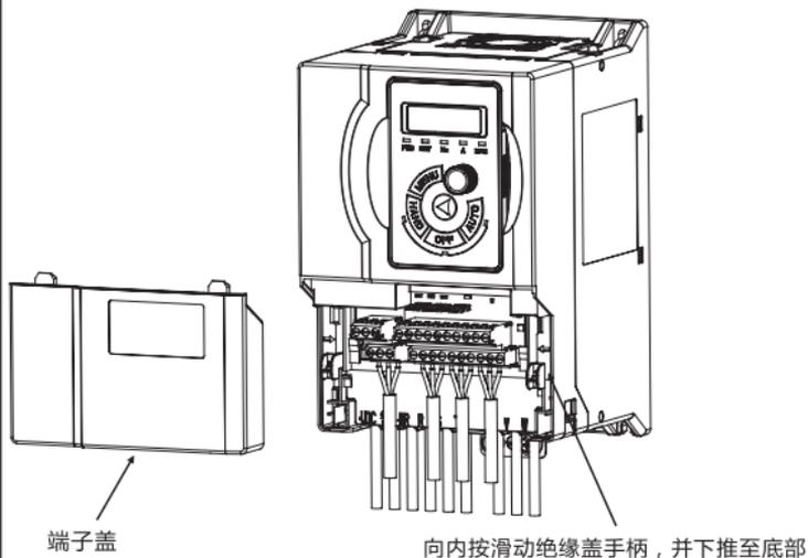
备注：如果滑动绝缘盖未滑下（如图所示），则端子盖无法装配到位。
