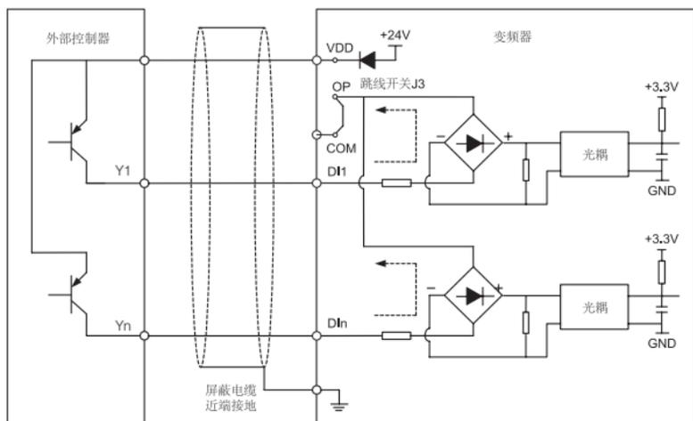
这种接线方式必须把跳线跳线开关J3的OP连接到COM上(即跳线开关J3使用PNP模式),否则不能正常工作。此用法仅对扩展型IO板有效。
