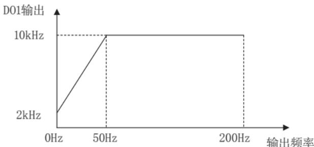
如果C05.63 = 80.00%（40Hz），C05.64 = 10.00%（5Hz），则变频器输出频率和DO1输出频率的关系如下图所示：
