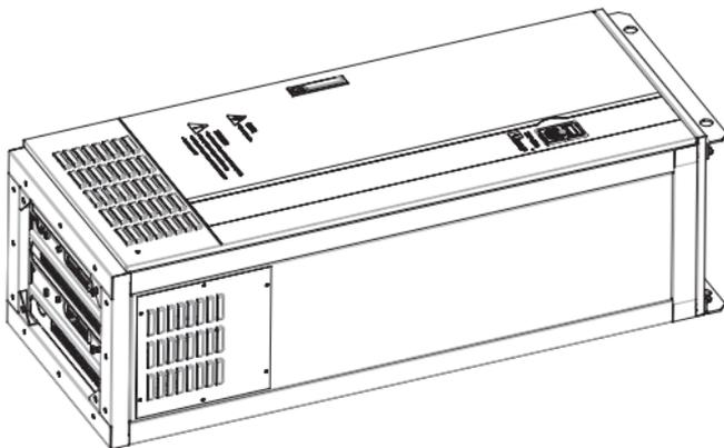
步骤2: 用12颗M8X20的螺栓将底座和变频器固定。
