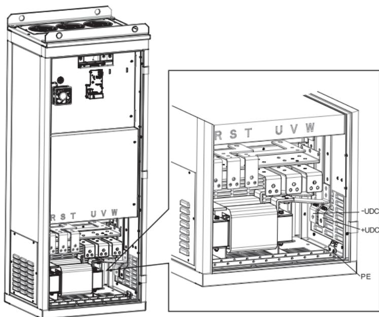
三相380V 250~415kW机型主回路端子示意图
