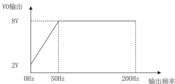
如果C06.73 = 80.00% (40Hz), C06.74 = 10.00% (5Hz), 则变频器输出频率和VO输出电压的关系如下图所示:
