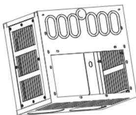
步骤4: 用M5 × 12的螺钉固定底座和变频器
