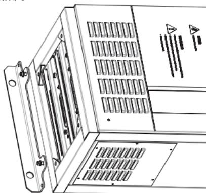
步骤3: 将变频器壁挂在控制柜中。
