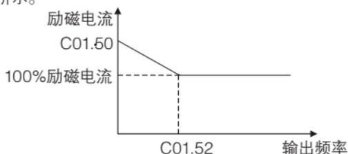
通过此组参数,可以在电动机低速运行时,在电动机上实现不同的热负载。
