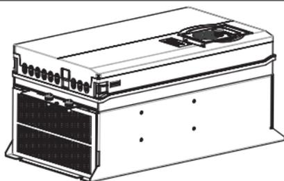
注意: 在安装滤网底座前, 请将机器内部絮状物清理干净, 以免再次堵塞散热器。
